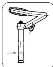
Püsttoru tuleb ohutuse tagamiseks sisestada vähemalt märgitud sügavusele, nagu on näidatud roolipostil, vt pilti. Keerake juhtraua püsttoru ülaosas asuv polt kinni.
