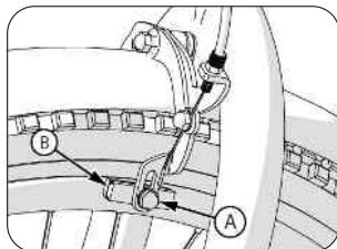
Iš abiejų pusių „Allen“ tipo raktu reguliuokite stabdžių trinkelės taip, kad jos liestūsi su metaliniu rato ratlankiu, o ne padanga. Įsitikinkite, kad stabdžių trinkelės yra tiesioje padėtyje, o tarpas tarp rato ratlankio ir dviejų stabdžių trinkelij būtų 1-1,5 mm.
